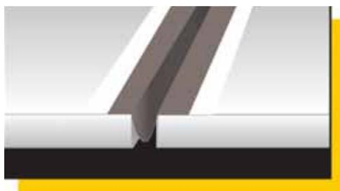
Schlaufenförmige Ausbildung von Mapeband PE 120 im Dehnfugenbereich
